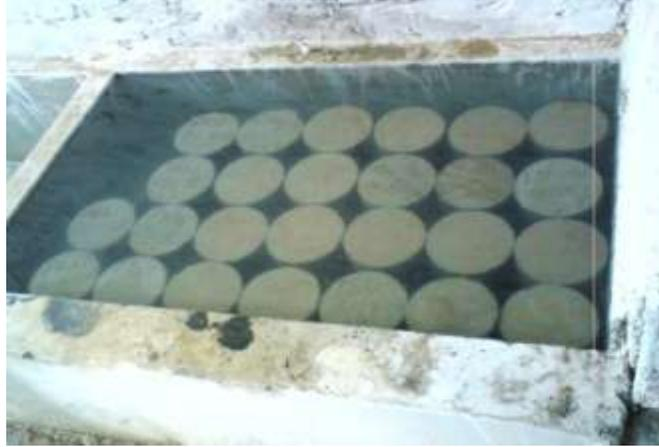
LAS FOTOGRAFÍAS SE OBSERVA LOS CILINDROS SUMERGIDOS EN AGUA, PARA SU CURADO Y ROTURA A DIFERENTES EDADES.
