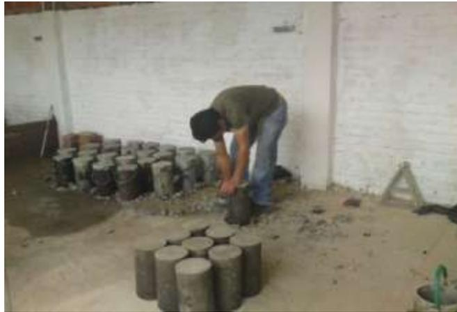
EN LAS IMAGENES SE OBSERVA EL DESENCOFRADO DE LAS PROBETAS DE HORMIGÓN, PARA SU POSTERIOR CURADO Y ROTURA A COMPRESIÓN.
