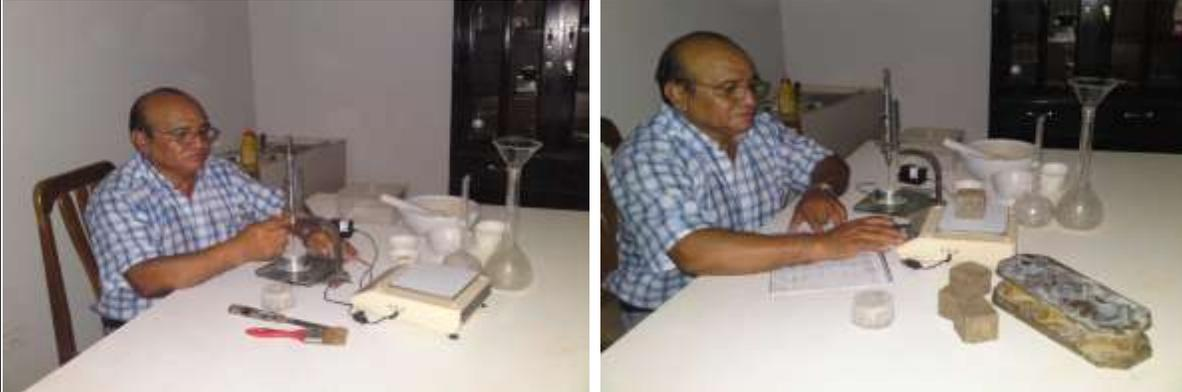
LAS FOTOGRAFIAS ILUSTRAN EL CONTROL DE CALIDAD DEL CEMENTO MEDIANTE LAS PRUEBAS DEL APARATO DE VICAT Y PROBETAS CUBICAS DE MORTERO A DIFERENTES EDADES
