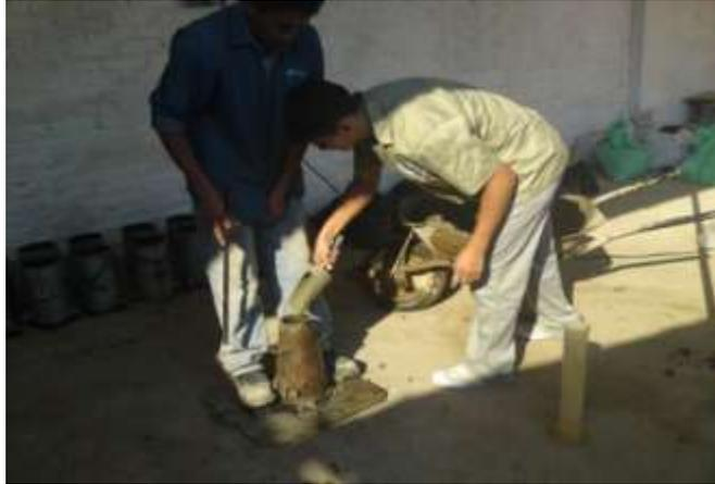
LAS FOTOGRAFÍAS ILUSTRAN EL VARILLADO PARA LA MEDICIÓN DEL ASENTAMIENTO .
