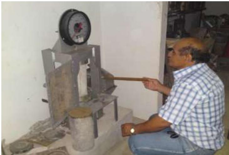
ROTURAS DE CUERPO DE PRUEBAS DE HORMIGON A COMPRESION A DIFERENTES EDADES.
